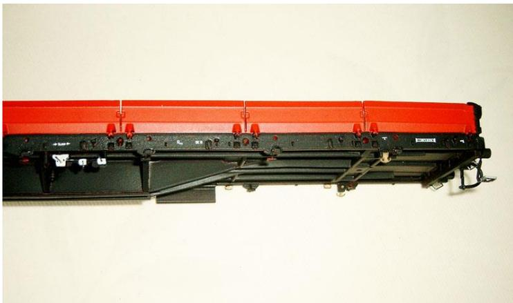
Puffer und Kupplungen werden weiter montiert.
