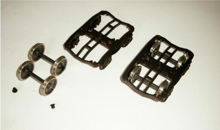
Die Drehgestelle werden ans Gehäuse angeschraubt.
